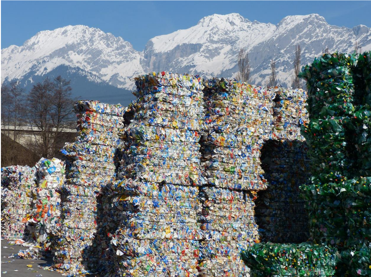
BU1: Aussortierte und zu Ballen gepresste PET-Flaschen in der Sortieranlage Höpperger (Foto: Höpperger.at)
